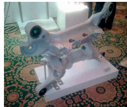
Hliníkový odlitek rámu motoru osobního automobilu
