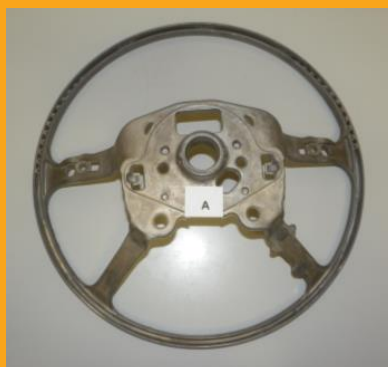
Odlitek tělesa volantu ze slitiny hořčíku (s. 168)
