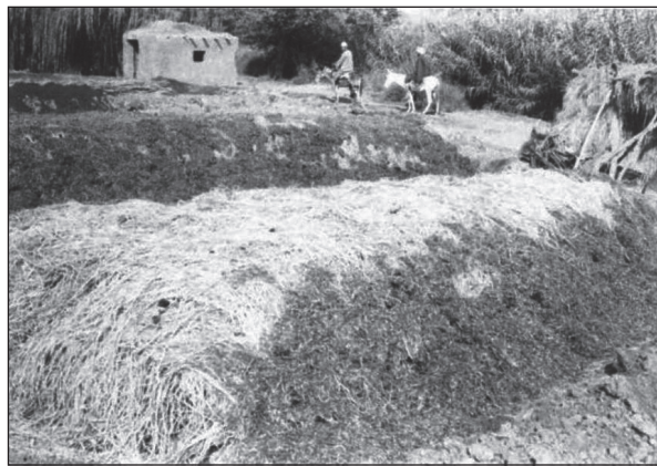
Obr. 12: Obdélníkové mělké uhelné jámy na deltě Nilu, dřevo je pokryté slámou a připraveno na pokrývání zeminou. Vlevo vzadu jsou patrné pozůstatky po dokončeném výpalu. Okolí delty Nilu (foto Kelley 2002)
