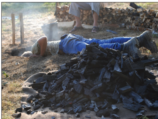
Obr. 19: Vybírání obsahu jámy vleže (J2, foto Jakub Kmošek)
