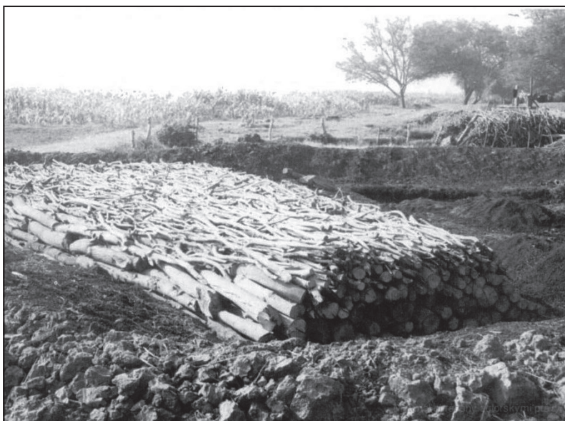
Obr. 11: Vsázka dřeva částečně převyšující mělkou jámu, povšimněte si skladebnosti dřeva a celkového zužujícího tvaru hromady. Severní Afrika (foto Kelley 2002)
