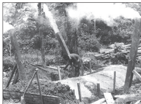
Obr. 10: Průběh suché destilace dřeva v jamách. Vznikající zplodiny jsou odváděny pomocí plechových komínů. Ghana, východní Afrika (foto FAO 1987)
