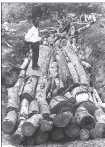
Obr. 9: Uhelné jámy při fázi nakládání. Povšimněte si velkých rozměrů polen, která lze úspěšně při výpalu použít. Ghana, východní Afrika (foto FAO 1987)
