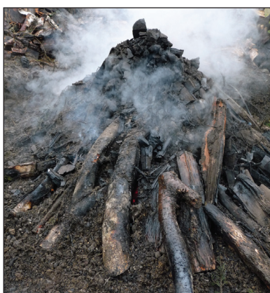
Obr. 24: M1 po odkrytí hliněného pláště, u vnějšího pláště vsázky jsou patrná nezuhlená polena (foto Jakub Kmošek)
