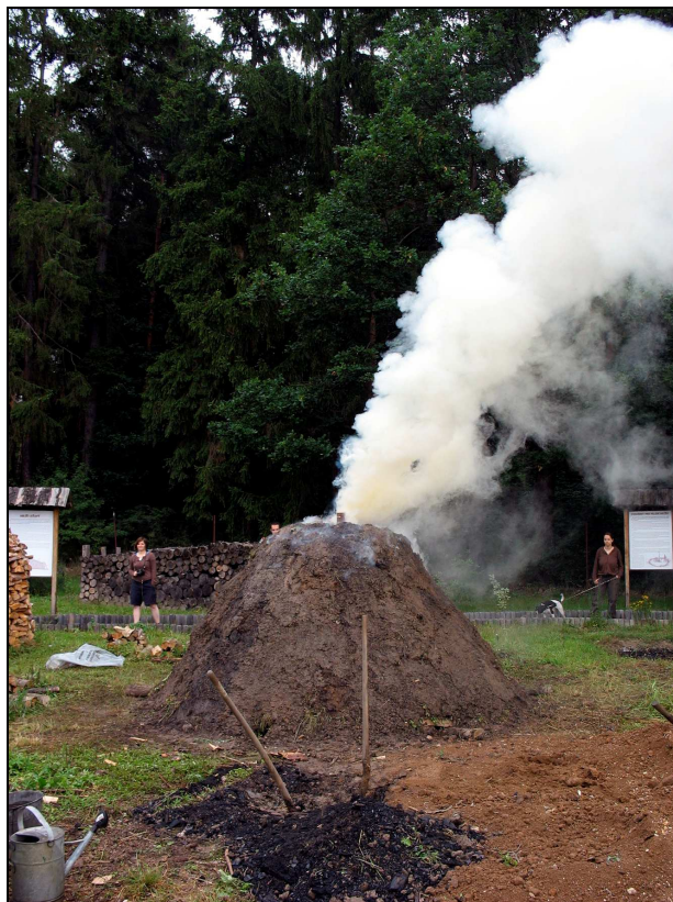
Obr. 5 Milíř je pokrytý vrstvou zeminy a mouru (2. „patro“). Těsně po zapálení milíř mocně dýmá z otvoru nad „králem“
