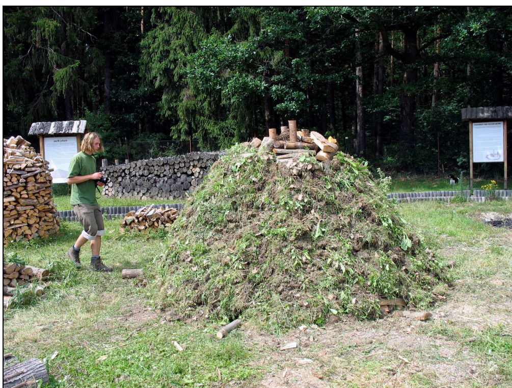
Obr. 4 Dřevěné těleso milíře je pokryté vrstvou (1. „patrem“) drnů
