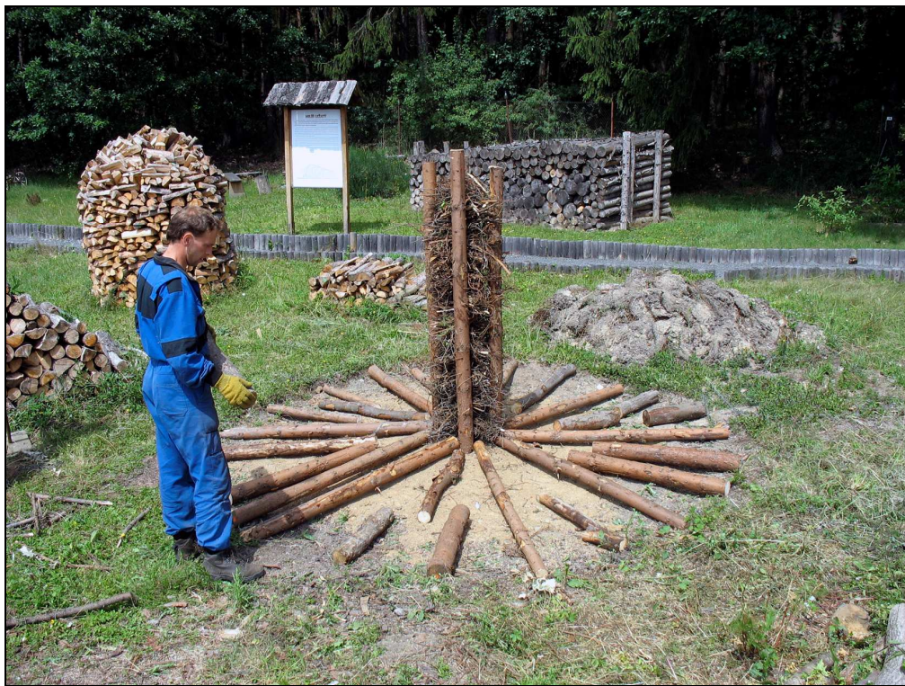
Obr. 1 „Král“ – zápalný komín a zároveň piliř konstrukce milíře umístěn v centru budoucího milíře. Na zemi položen rošt izolující dřevo od země
