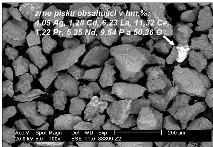
Obr. 4 Zobrazení částice s těžkými kovy obsahující v hm.% 4,05 Ag, 1,28 Cd, 6,23 La, 11,32 Ce, 1,22 Pr, 5,35 Nd, 9,54 P a 50,36 O, v módu BSE
