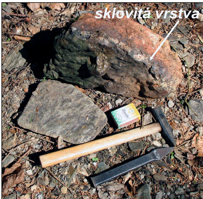
Obr. 5 Balvan z hromady vlevo od pece pokrytý sklovitou vrstvou strusky
