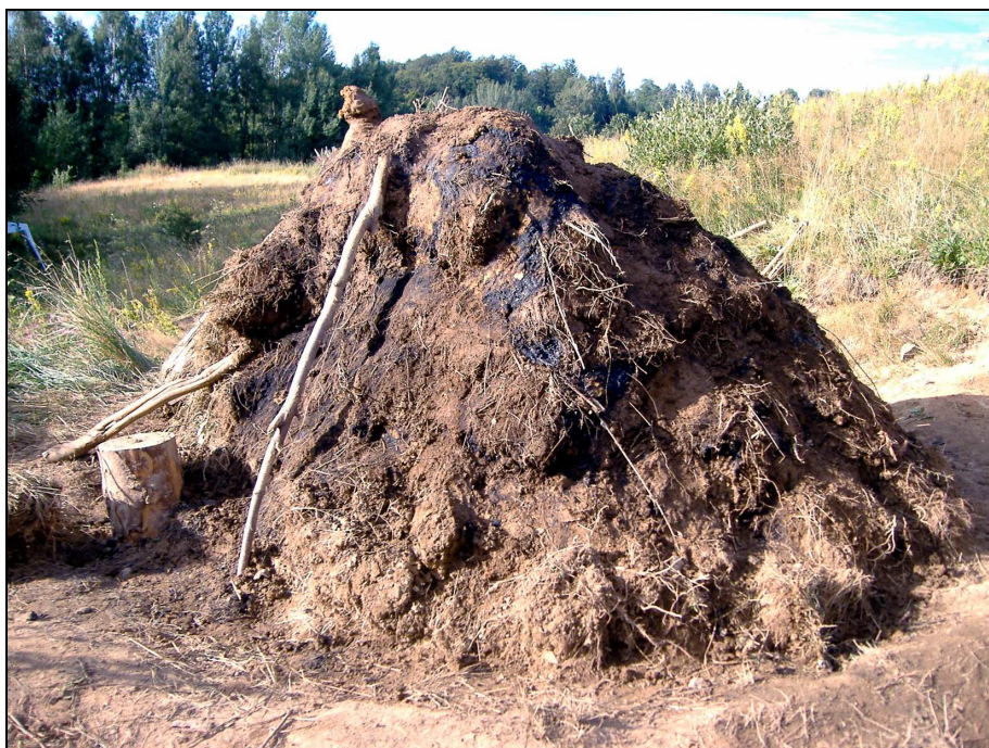
Obr. 7 Uhřínov pod Deštnou v Orlických horách, zapálený milíř před utěsněním
