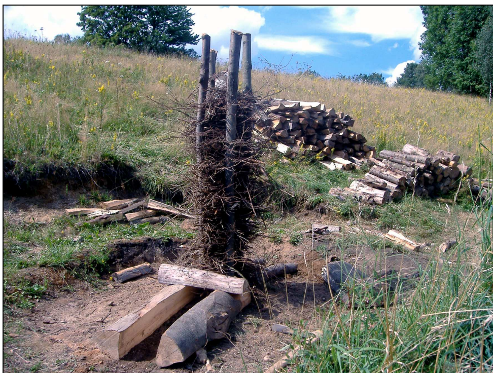
Obr. 5 Uhřínov pod Deštnou v Orlických horách, stavba milíře – král
