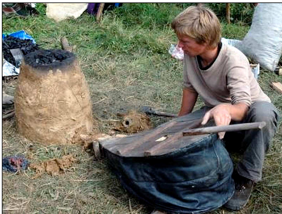
Obr. 4 Sebranice u Litomyšle, experimentální železářská kusová pec typu Podbořany při práci
