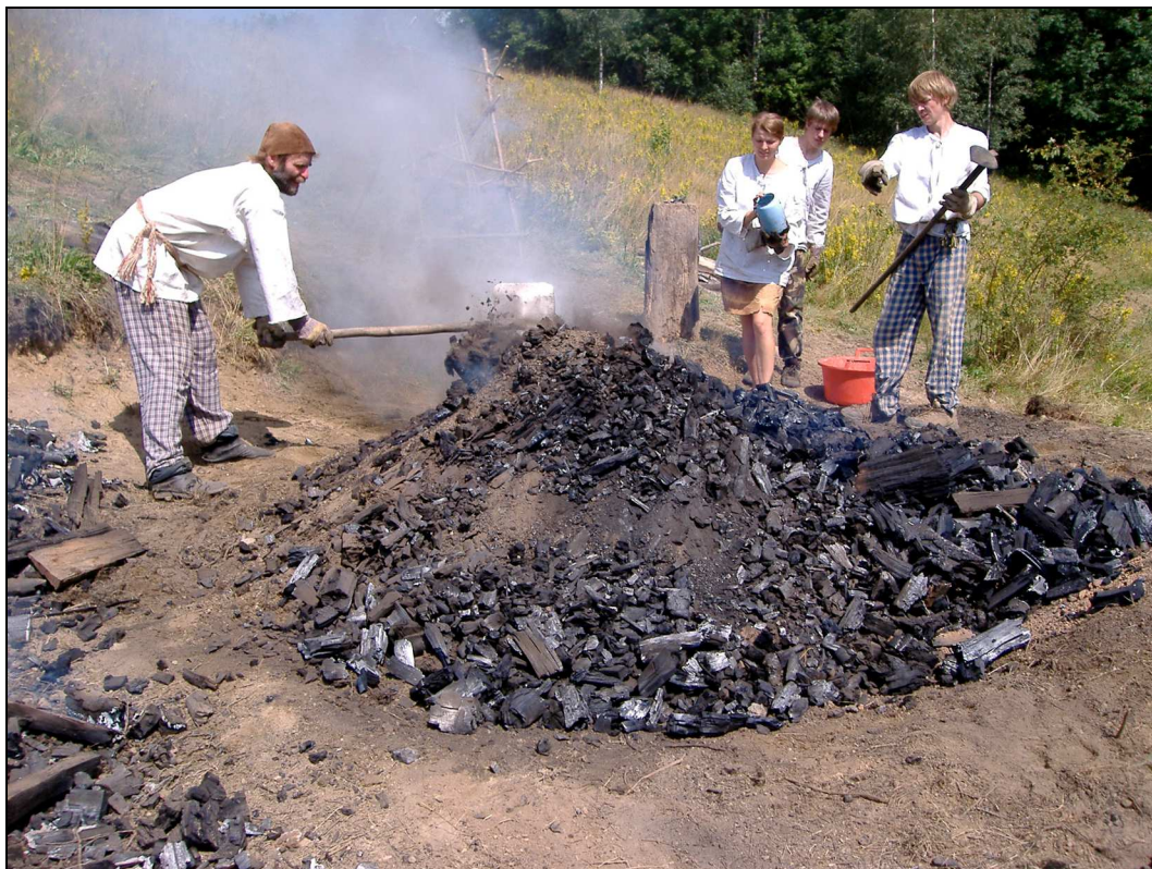
Obr. 9 Uhřínov pod Deštnou v Orlických horách, rozebírání milíře
