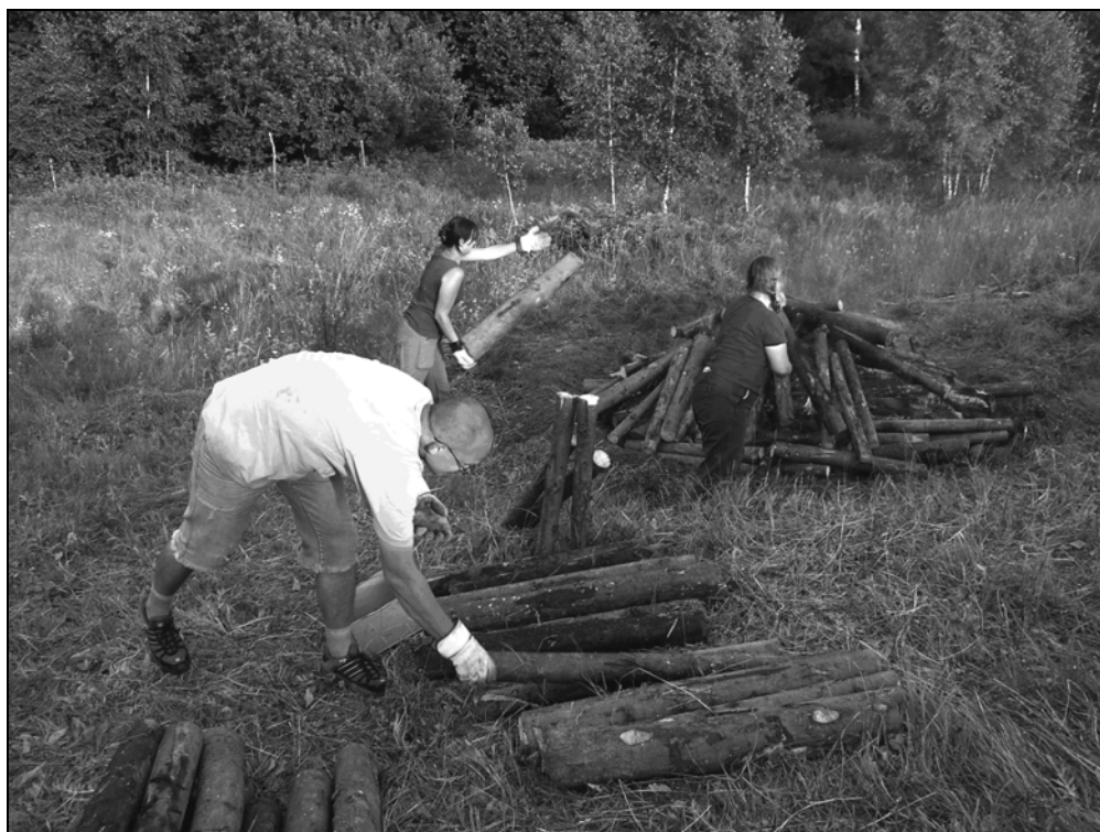
Obr. 5 Experimentální výroba potaše – spalování smrkového dřeva. Uhřínov pod Deštnou (foto K. Woitschová – Kučerová, 2005)
