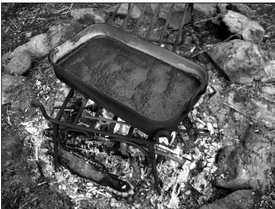
Obr. 10 Experimentální výroba potaše – odpařování výluhu ze smrkového popela intenzivním varem. Uhřínov pod Deštnou (foto J. Woitsch, 2004)
