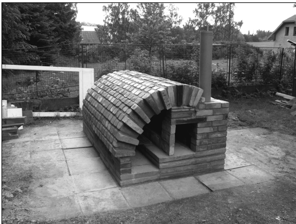
Obr. 17 Experimentální výroba potaše – kalcinační pec. Deštné v Orlických horách (foto J. Woitsch, 2004)
