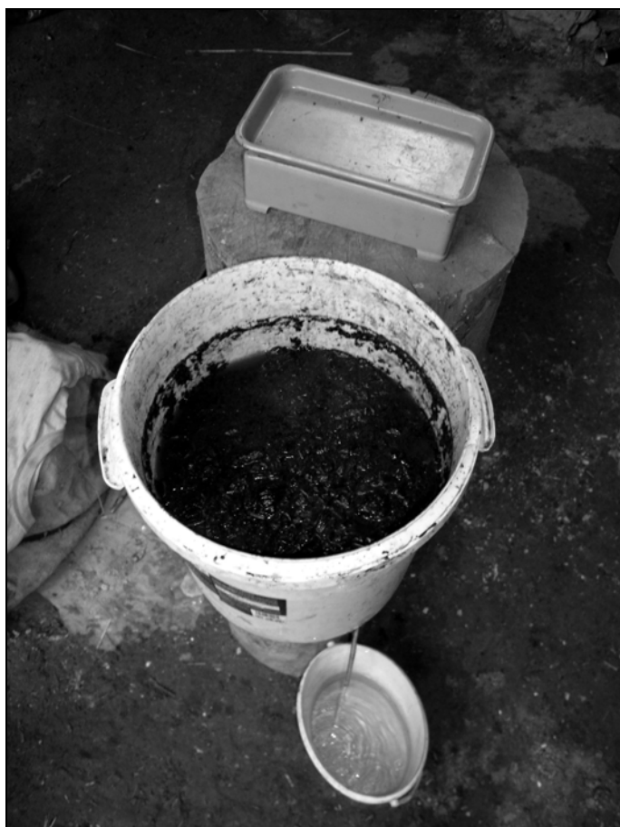
Obr. 8 Experimentální výroba potaše – vyluhování popele vodou. Uhřínov pod Deštnou (foto J. Woitsch, 2004)
