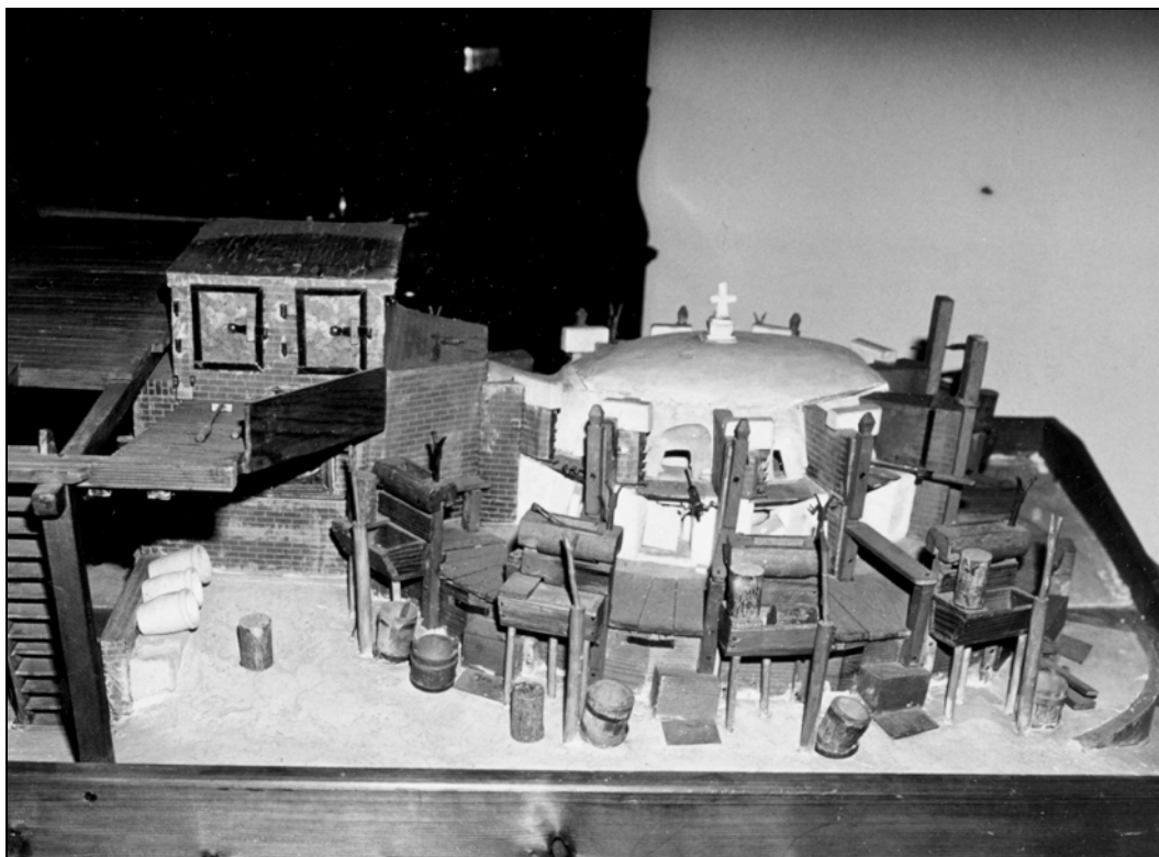
Obr. 7 Pohled na model sklářské pece z 2. poloviny 19. století na otop dřevem. Model provedl bývalý huťmistr František Rückl z Kamenického Šenova v polovině třicátých let 20. století. V levém dolním rohu snímku pod pódium jsou plechová dvířka chladič komory, vlevo od nich leží tři chladič hrnce. Sběrka Uměleckoprůmyslového musea v Praze, původně Jílkova sbírka z Kamenického Šenova. Foto z přelomu šedesátých a sedmdesátých let 20. století; archiv autora
