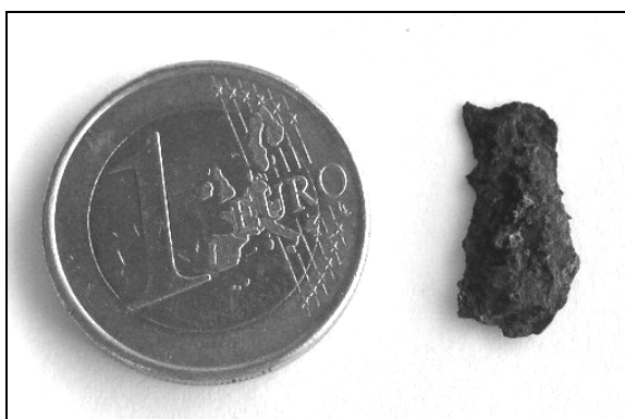
Obr. 13 Fragment osteňu sekerky vyšetovaný Mössbauerovou spektrometriou v odrazovej geometrii
