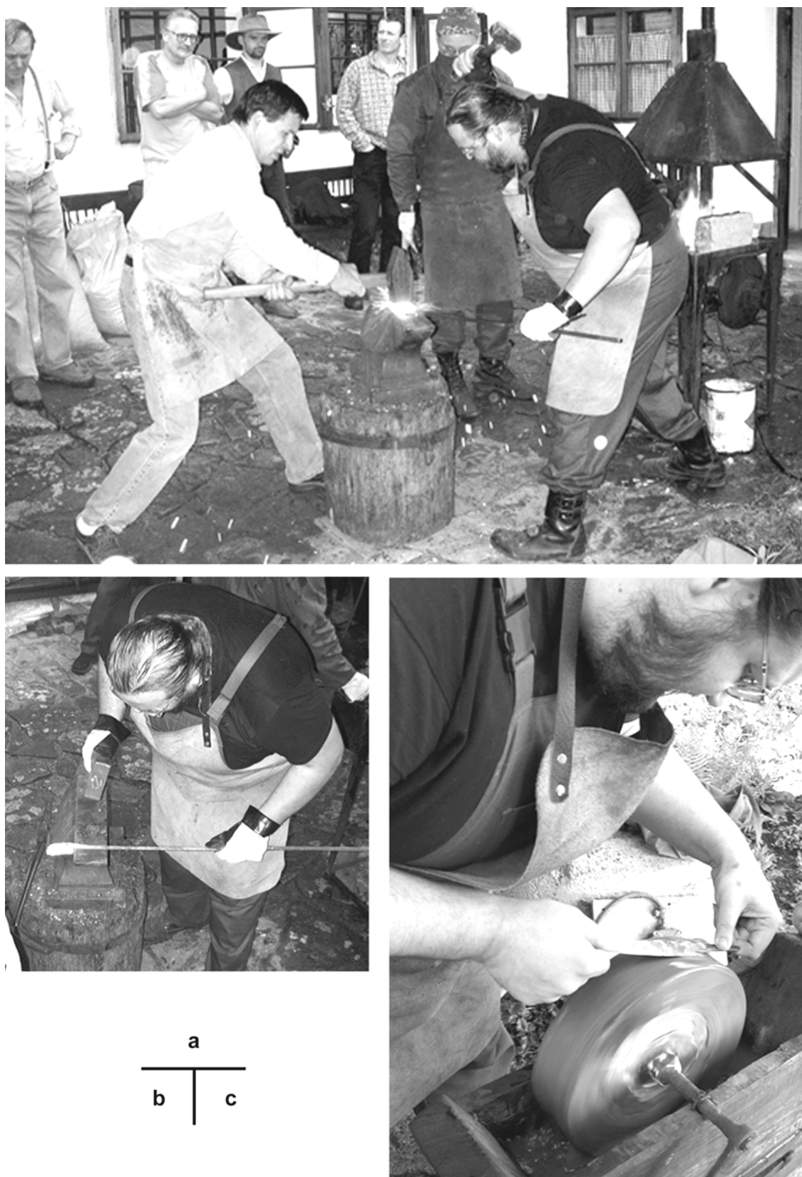
Obr. 2 Kovářská práce mistra Laskyho v Těšanech; a, b – prokovávání polotovaru; c – broušení čepele nože na ručním brusku
