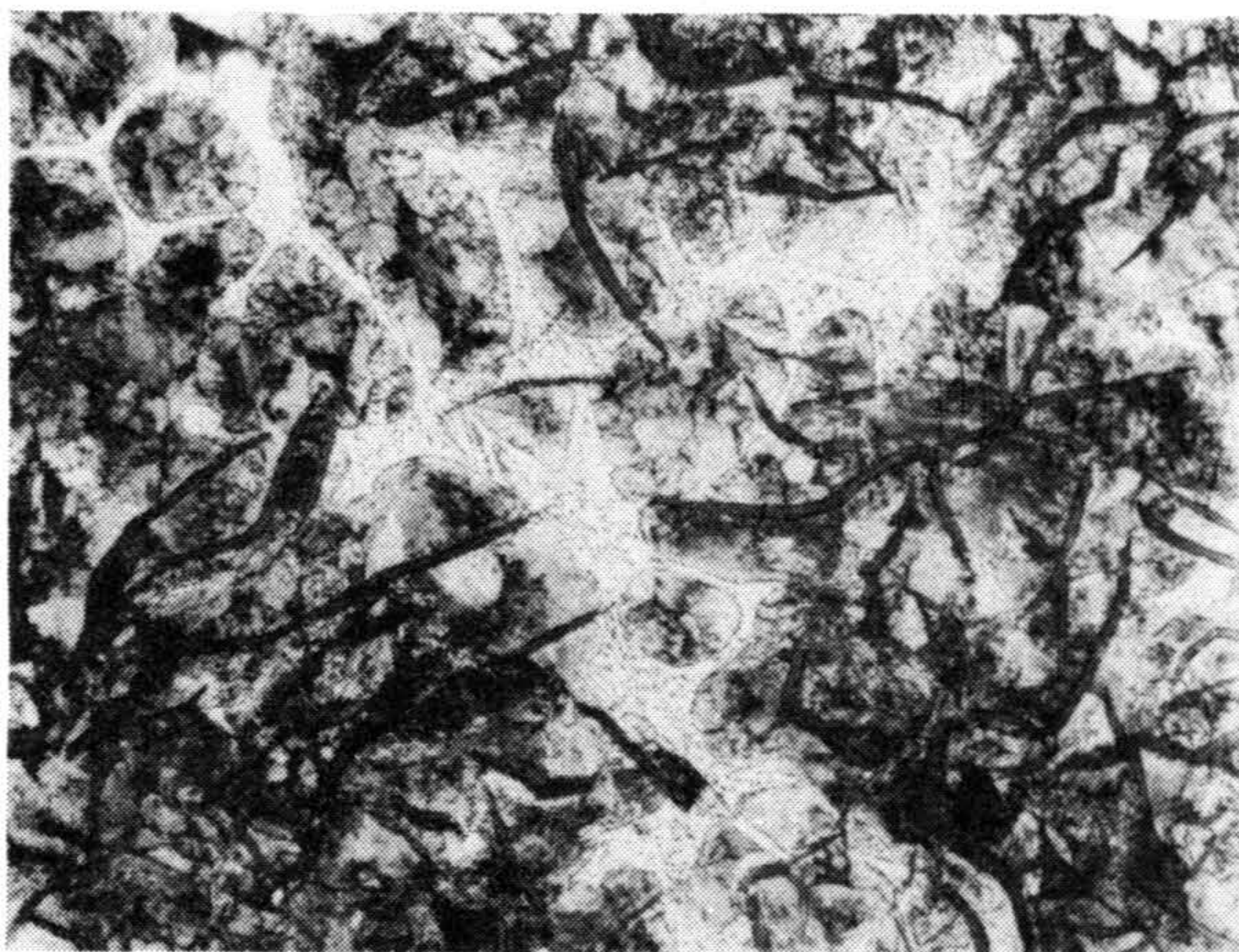
Obr.12 Grafit ve vzorku šedé litiny z Bolíkovské huti. Neléptáno, zvětšeno 100x.
